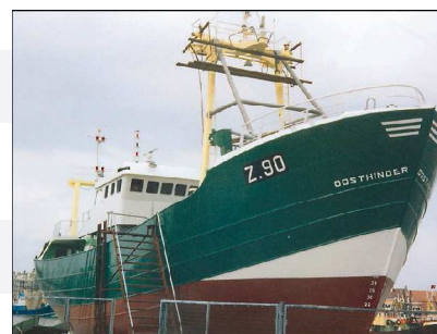
Hiekkapuhallus SA 2.5 ZINGA 1 x 80 \mu Pinta Pu 1 x 80 \mu
