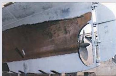
Hiekkapuhallus SA 2.5 ZINGA 1 x 80 \mu (korkeapaineisella ruiskulla) Eristys MIO 1 x 60 \mu Päällikerros Pu 1 x 60 \mu
